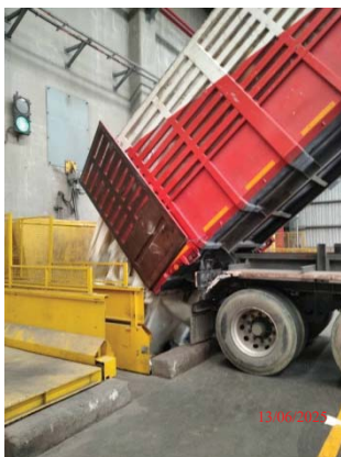
รูปที่ 17 กิจกรรมการเทกากอุตสาหกรรมลงบ่อรับกากอุตสาหกรรม และการย่อยกากอุตสาหกรรมภายในอาคารรับกากอุตสาหกรรม
