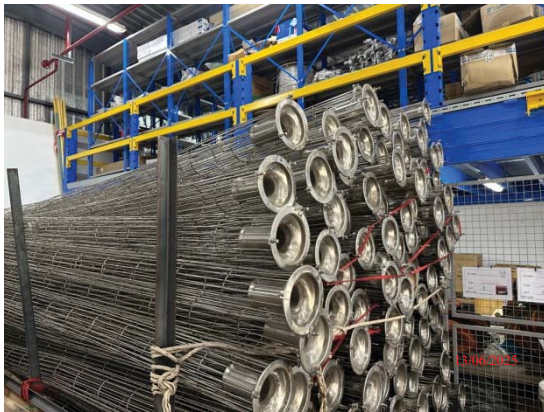
รูปที่ 13 อุปกรณ์และอะไหล่ของระบบ ดักฝุ่นละอองของหม้อไอน้ำ
