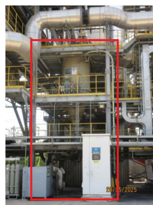
รูปที่ 8 ระบบฉีดพ่นผงถ่านกัมมันต์เพื่อดูดซับ โลหะหนัก และสารประกอบไดออกซิน
